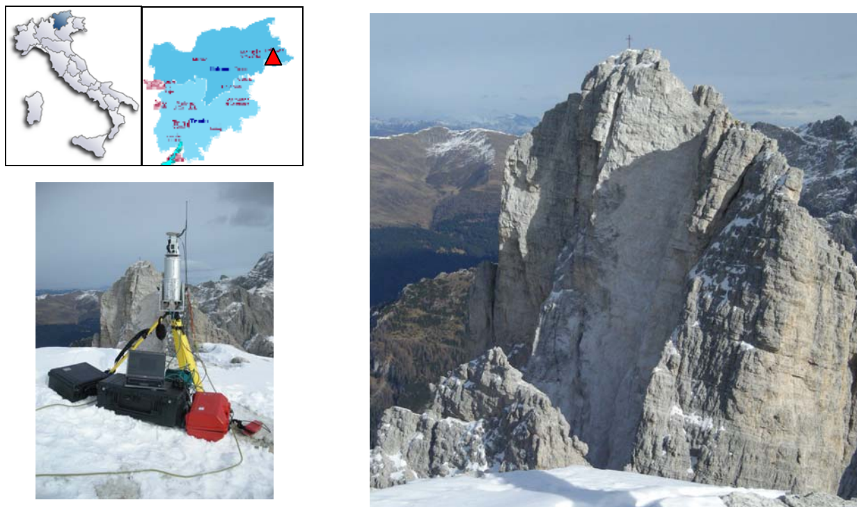
Figura 1 - Sinistra: localizzazione del sito di studio e foto della strumentazione utilizzata per il rilievo TLS. Destra: Nicchia di distacco su Cima Una vista dal punto di ripresa TLS.
