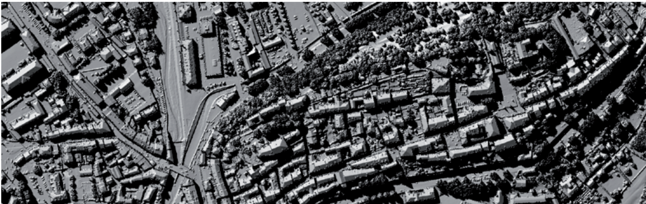
Il modello digitale del terreno prodotto nel centro storico di Feltre ottenuto da rilievo LiDAR
